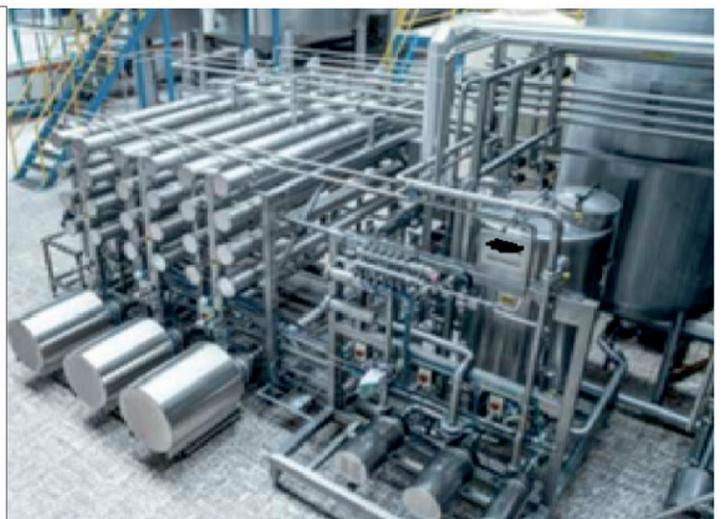
**Ilustração e skid de um conjunto de membranas industrial**
