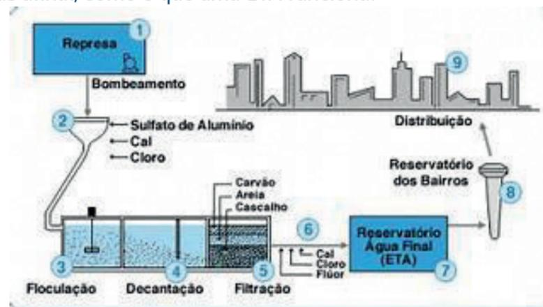
Etapas de uma ETA (1. Captação, 2. Coagulação, 3. Floculação, 4. Decantação, 5. Filtração, 6. Cloração, 7 e 8. Reservatórios, 9. Distribuição)
