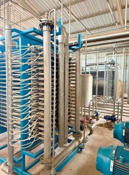
pliação. O diferencial técnico está na disposição dos módulos em espiral, favorecendo a distribuição uniforme do fluxo e minimizando o risco de fouling – incrustação nas membranas – um dos principais desafios operacionais em processos de filtração.
